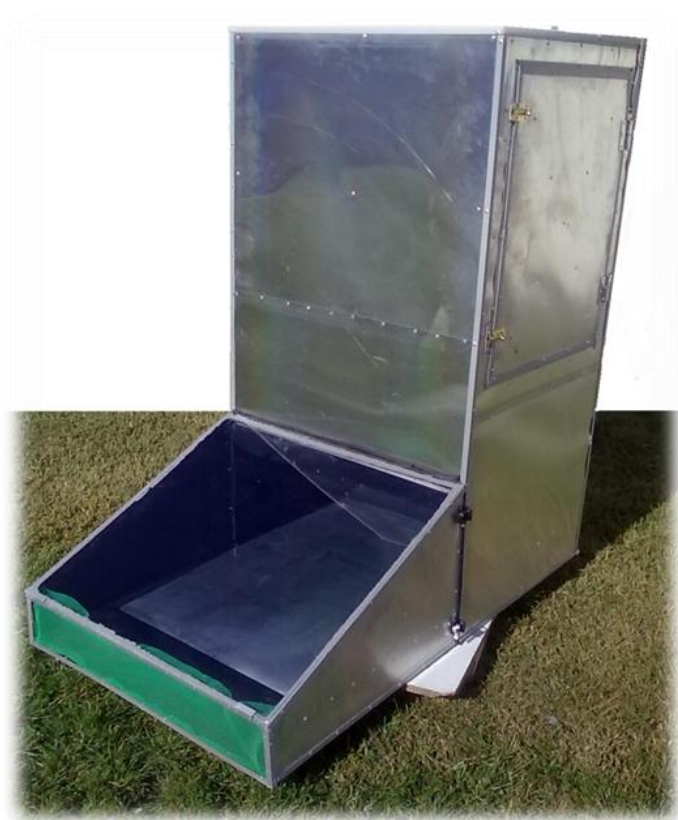
Figura 27. Prototipo de Deshidratador Solar terminado.
