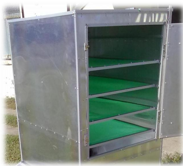
Figura 28. Imagen Interior del Prototipo con bandejas para deshidratar.
